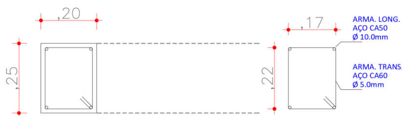
Imagem 09. Detalhe técnico, seção das vigas e armaduras.
