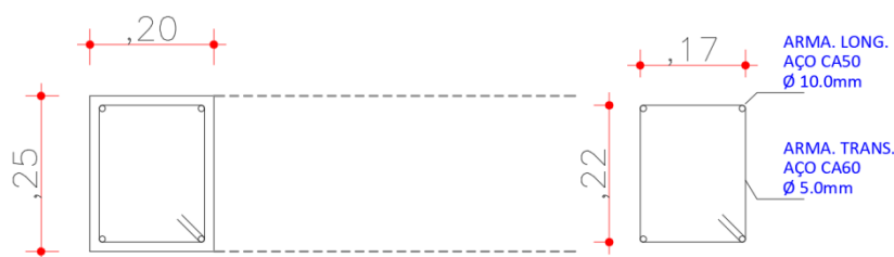
Imagem 09. Detalhe técnico, seção das vigas e armaduras.
