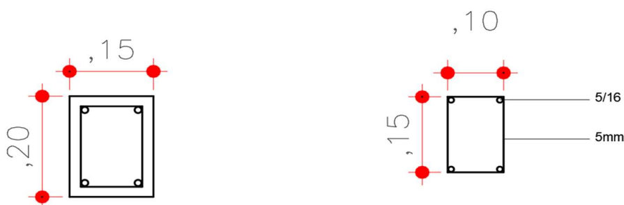
Imagem 16 - Seção das contra verga das janelas e detalhes da armadura long/trans.
