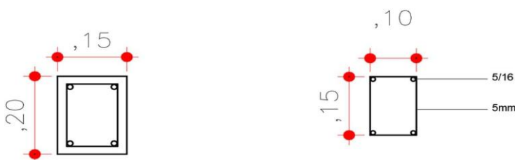
Imagem 16 - Seção das contra verga das janelas e detalhes da armadura long/trans.
