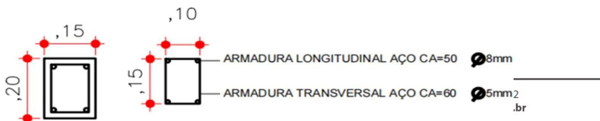
Imagem 12: Seção das contra verga das janelas e detalhes da armadura long/trans.
