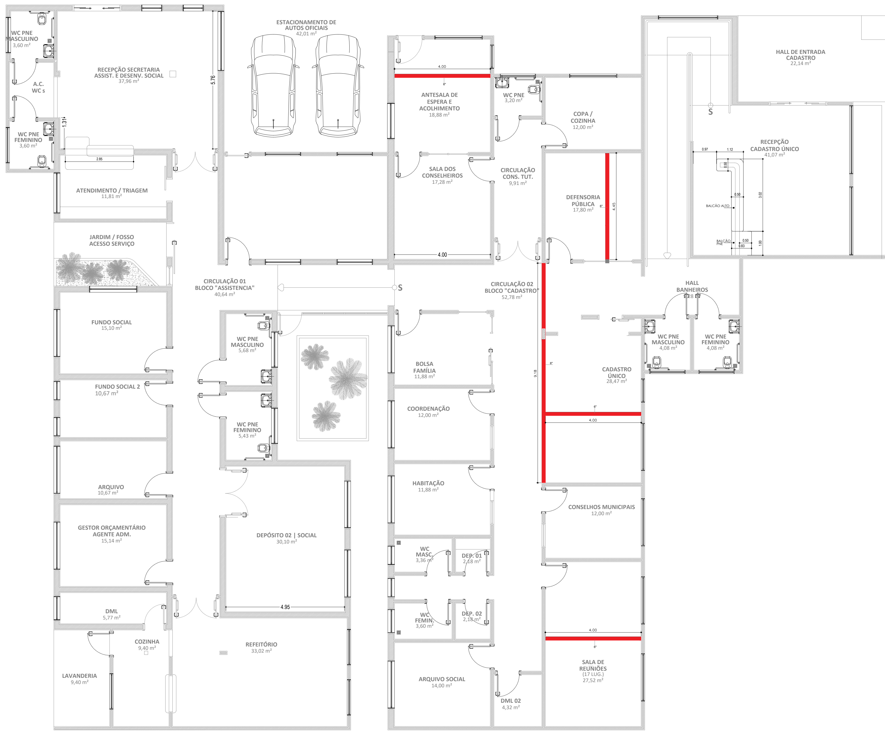
MAPA VIGA DE APOIO METLALICA TIPO "I" RETROFIT PRÉDIO AVENIDA TARUMÃ ESCALA 1:75
