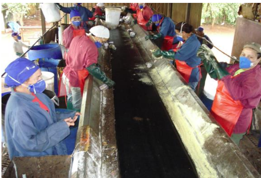
Foto 1 - Separação de material coletado (PGRS).
